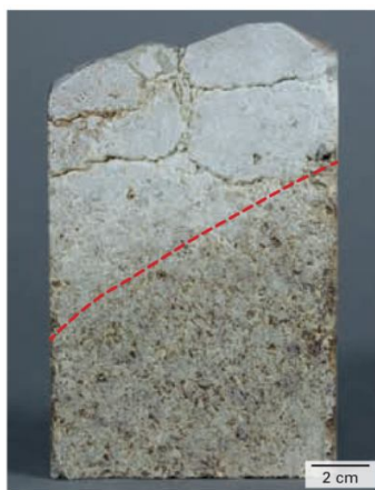
شکل 4: عمق نفوذ سرباره در آجر دولومانی باند مستقیم کار کرده، نشان داده شده است. ترکها عمدتا موازی با سطح داغ آجر و در ناحیه نفوذ قرار دارند. فرسایش گرم باعث سایش یکنواخت شده و زمانی که بخش ترک خورده از آجر جدا می شود فرسایش غیر یکنواخت یا سرشکن شدگی شروع می شود. مرز بین مناطق نفوذ و بخش سالم با خط چین قرمز مشخص شده است.
